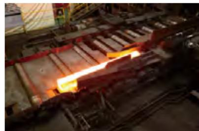
金属加工に用いる圧延機。圧延ロールの組替え時に鋼材の温度を上げ過ぎず下げ過ぎない制御を行い、省エネルギーを実現している。
