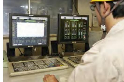
管理室に設置されたSORTIA-MPC。加熱炉内の最適温度をシミュレーションし、コントロールしている。オペレータはさらに生産に注力できるようになった。
