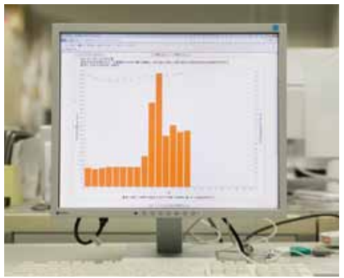
savic-net FX BMS。CO 2 排出量と外気温の変化を1枚のグラフで表示するなど、エネルギーの利用状況を把握することができる。また、課金データも管理している。
