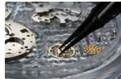
機械式腕時計を構成するパーツは100点以上。形や大きさの異なるネジや歯車を、一つひとつ製作し組み立てていく。
