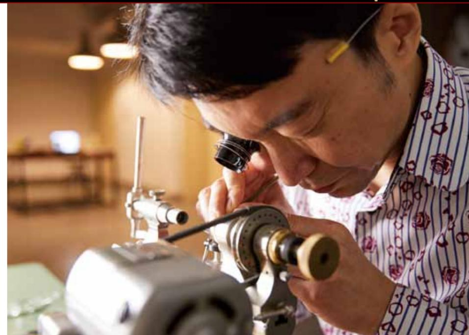
時計旋盤という機械で部品の加工を行う浅岡さん。一切の妥協を許さず、緻密な作業を続ける。
