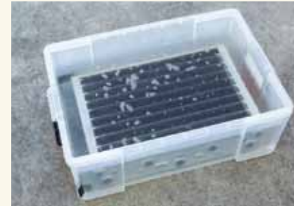
電子式エアクリーナの集じんセルは専用施設でクリーニングを行い、リユースしている。写真はお客さま宅で1年間使用した集じんセルを、透明な洗浄液に投入したところ。
