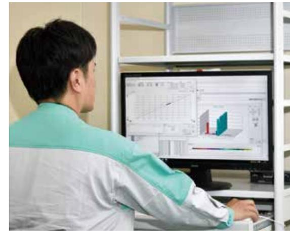
Valstaffの調節弁オンライン診断で表示したグラフ。バルブの稼働状況の確認、異常予兆の検知に加えて、オンラインまたはオフラインでの診断機能を利用したバルブの検査などもパソコンからの操作で行える。
