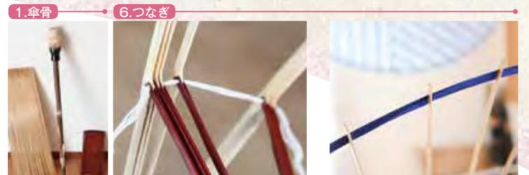
1. 傘骨 骨に開けた穴に糸を通して傘の骨格を組み立てる。
