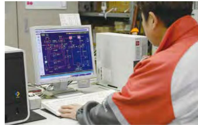
総合センターの中央監視室に設置されたsavic-net EVmodel30。しあわせの村内の主要施設に設置された中央監視システムと連携して、それら施設の設備状況を一元的に監視できるようになっている。
