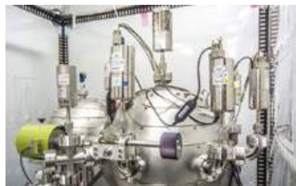
真空計の校正を行う膨張法装置。容積の異なる数種の容器から成り、ボイルの法則に基づいて、小型の容器に閉じ込めた気体を大型の容器に膨張させ低圧を発生させる。膨張前後の容積比を正確に求めることで、膨張後の圧力を正確に決定することができる。
