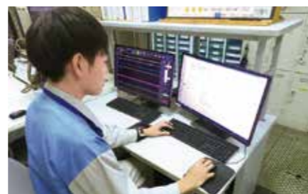
BiG EYESのトレンド監視ビューア(左)とコンフィギュレータ(設定)画面(右)。監視対象に関連するポイントを登録し監視モデルを作成する。他社DCSとオンラインで接続し監視を行う。
