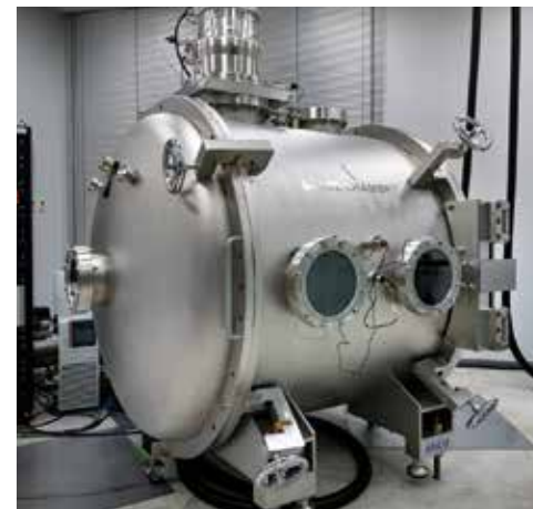
(左) スペースチャンバー／真空状態を作り、宇宙空間に近い環境で衛星の各種機器が正常に動作することを確認すると同時に、人工衛星の温度を検証。(右上・右下) アーク風洞(自社開発)とその内部／高温のガスを噴射することで大気圏投入を疑似的に再現。流星源の発光実験を行うほか、大気圏突入による蒸発・侵食のメカニズムを研究し、材料の設計・開発に役立てる。
