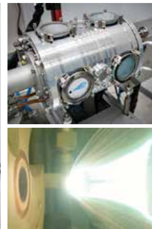
(左) スペースチャンバー／真空状態を作り、宇宙空間に近い環境で衛星の各種機器が正常に動作することを確認すると同時に、人工衛星の温度を検証。(右上・右下) アーク風洞(自社開発)とその内部／高温のガスを噴射することで大気圏投入を疑似的に再現。流星源の発光実験を行うほか、大気圏突入による蒸発・侵食のメカニズムを研究し、材料の設計・開発に役立てる。
