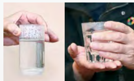
熱湯を入れると、左の耐熱ガラスは側面が熱くなり緑しか持つことができない。右のHarehareのガラスは側面が熱くならないため、両手で持てる。
