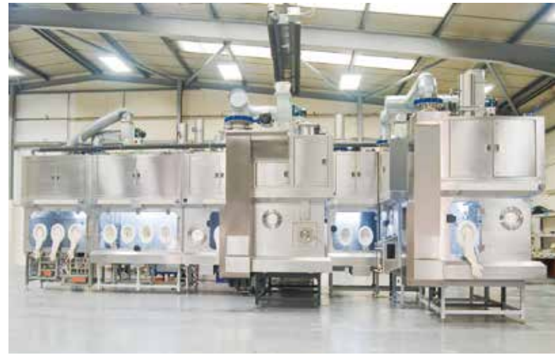
アズビルテルスターが提供するアイソレータ。隔離されたユニットの中で有害・有毒なプロセス処理を行うことで作業者の安全を守るための装置。
