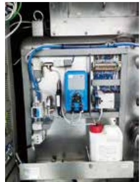
アイソレータ内に装備されているアズビルテルスターのionHP+。アイソレータでのプロセス終了後、過酸化水素水を用いてハウジング内の滅菌作業を実施する。
