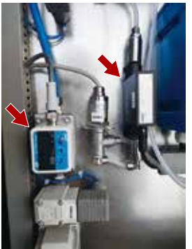
20mL/分という微小な過酸化水素水を流す熱式微小液体流量計(形 F7M)(右)と、過酸化水素水と空気を均一に混合して噴霧する際に用いられるエア管理用メータ(左)。
