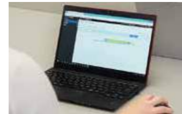
ビル向けクラウドサービス TSの空調延長予約画面。テナントのPCやスマートフォンの画面から、オフィス内の空調ゾーンごとに空調運転時間の延長申請をすることができる。また同様に室内温度設定の変更も可能。
