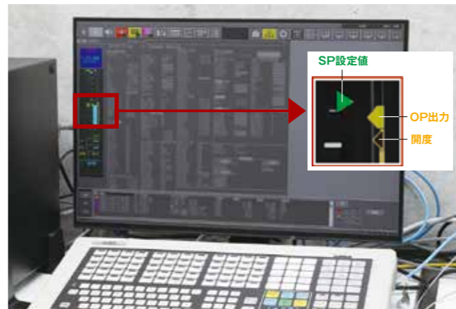
Harmonas-DEOの監視画面左側に表示されたフェイスプレートには、視覚的にその差異が確認できるように、バルブに対して行った開閉の指令の値とHART変数として受け取った実際の現場のバルブ開度を並べて表示している。
