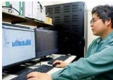
サーバ室に設置されたEMSのEneSCOPE(手前)とDCSのHarmonas-DEO(奥)のモニタ画面。
