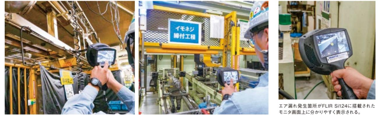
工場内の高所の配管や人が入りにくい設備の中も、離れた場所からFLIR Si124でエア漏れを検知できる。
