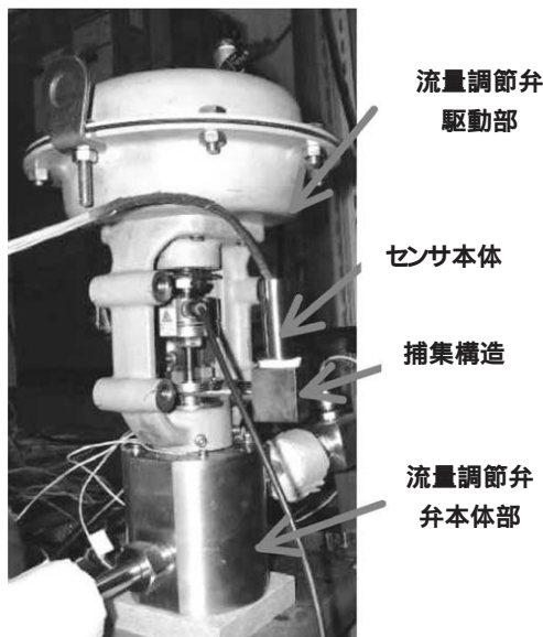
図14. バルブへの取り付け状態
