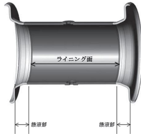
図7. 電池電磁の流体測定部
