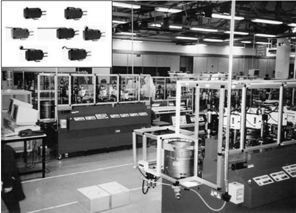
図1. マイクロスイッチ自動化ライン
