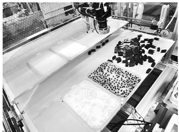
図10. 平置き部品供給装置
