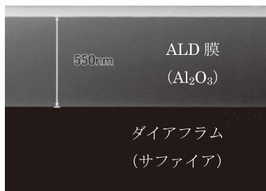
図3 センサダイヤフラム上に堆積したALD膜のSTEM写真と分析箇所
