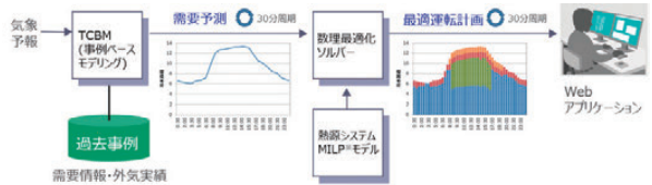
図1 熱源最適計画 処理概要
