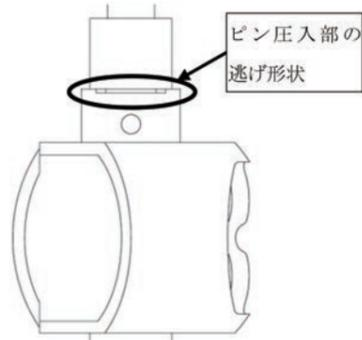
図4 ステムの傾きを防止するためのプラグ構造
