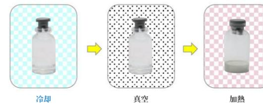
図6 凍結乾燥処理
