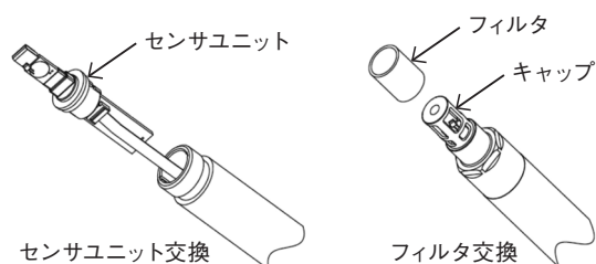
図16 センサ計測部の交換箇所
