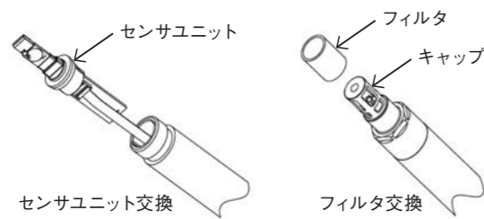
図16 センサ計測部の交換箇所
