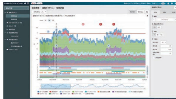
図6 エネルギー管理画面事例(熱源最適運用)
