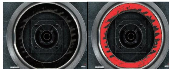
図13 拡散接合面の画像処理による接合評価
