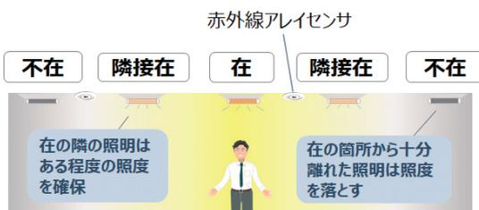
図13 照明の隣接在制御
