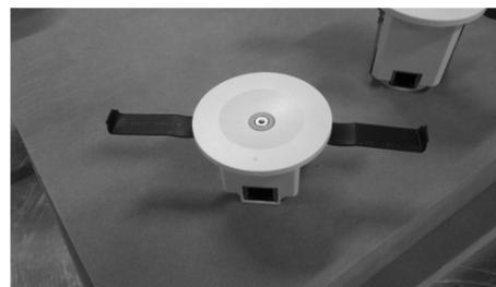
図5 試作した赤外線アレイセンサ
