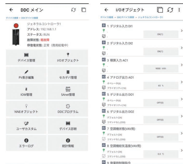
図3 スマートフォンで動作する現場エンジニアリングツール
