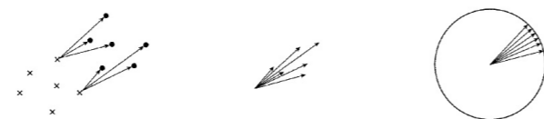
図8 確率分布に変化がある時の差分ベクトルの取得と正規化の様子
