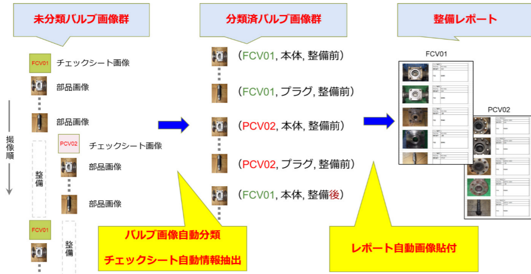
図7 バルブ整備レポート支援の処理フロー
