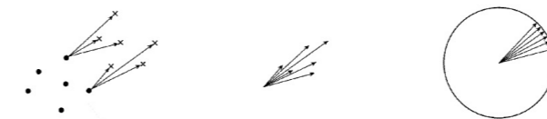
図10 ●からXに対して差分ベクトルの取得と正規化
