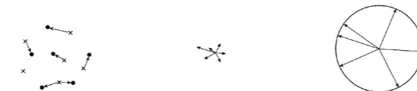
図9 確率分布に変化がない時の差分ベクトルの取得と正規化の様子
