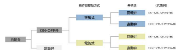
図1 ON-OFF弁の操作器駆動方式と弁構造
