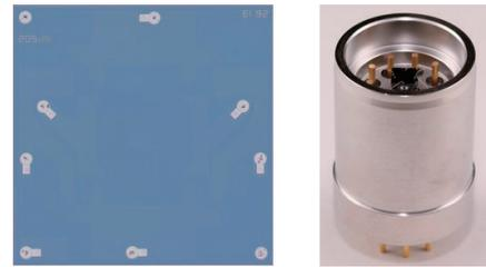
図6 ピエゾ抵抗式圧力センサのチップとパッケージ
