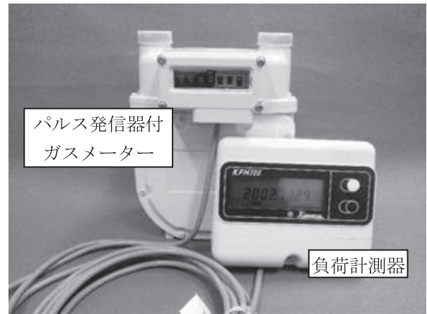
図3. パルス発信器付ガスメーターと負荷計測器
