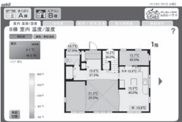
図 4-2. 見える化システム (温度分布)
