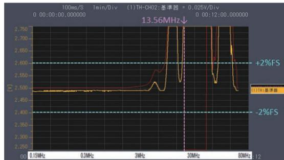
(b) EUT:非絶縁の従来デジタルマスフローコントローラ
