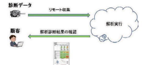
図16 クラウド形式でのバルブ解析診断
