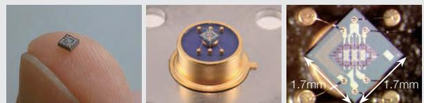
独自開発の気体流量計 MEMSセンサ(マイクロフローセンサ™)
