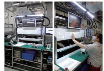
※ 触覚・視覚・知能等の人の持つ能力を機械化して工程を自動化し、機械の持つ正確さと人の柔軟性を兼ね備えたシステム。機能はモジュール化されているため再利用が行え、生産設備の変更や拡張に柔軟に対応可能。
