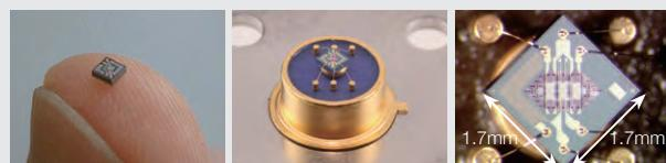
独自開発の気体流量計 MEMSセンサ(マイクロフローセンサ<sup>TM</sup>)
