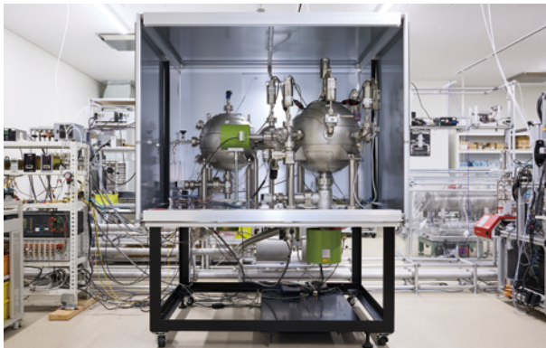
藤沢テクノセンター校正室と高い精度を誇る真空校正装置（中央）
