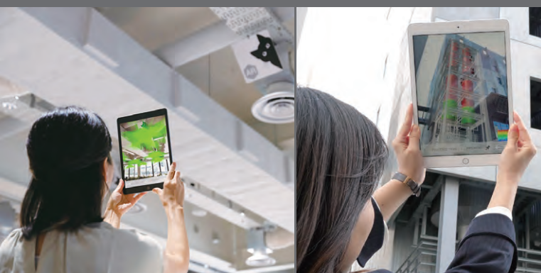
空調吹出口から、どれくらいの温度、どれくらいの風量で風が出ているのかをARで視覚的に確認できる
