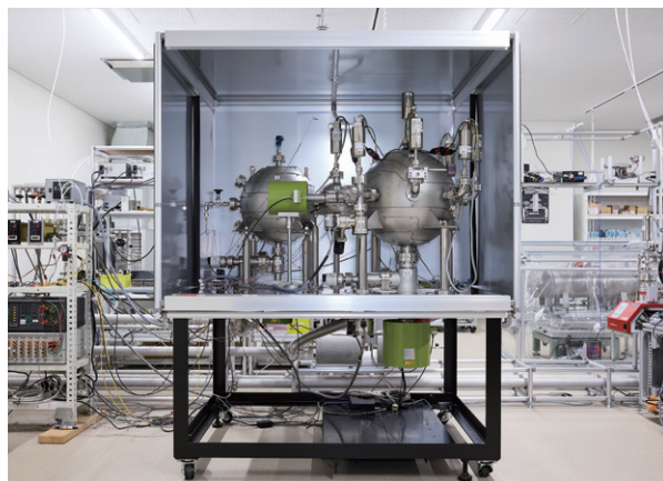
藤沢テクノセンター校正室と高い精度を誇る真空校正装置（中央）
