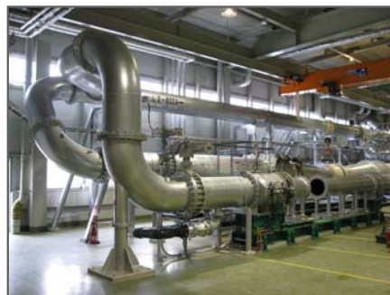
京都工場・アジア最大規模 の実流校正装置
