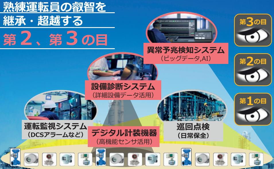
監視システムや巡回による監視を「第1の目」とすると、高機能センサのデータに基づく設備診断（「第2の目」）、そしてビッグデータを活用した異常予兆検知（「第3の目」）を活用した、世界に先駆けた「スマート保安」を提唱
