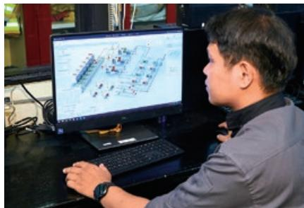
BEMSとして新たに導入されたsavic-net G5の監視画面。設備の稼働状況を分かりやすいグラフィックで確認することができる。
