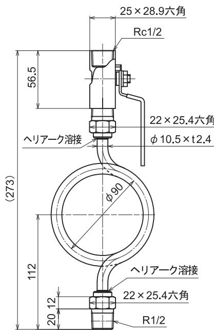
図2 サイホン管 (コック組付)の外形寸法図 (mm)
