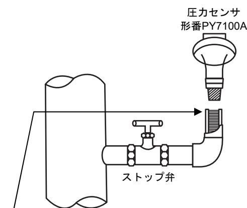
満水状態でねじ込むと7~10MPaの圧力が圧力センサにかかり、再現性が失われる所以少なくとも30mm以上の空気層部分を設けてからねじ込んでください。
