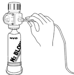
図7 ガス供給チューブの取付
