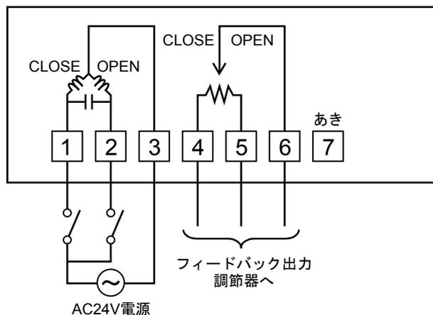
(注記) 端子4-6間の電圧値をフィードバック信号として読み取るコントローラを推奨します。
