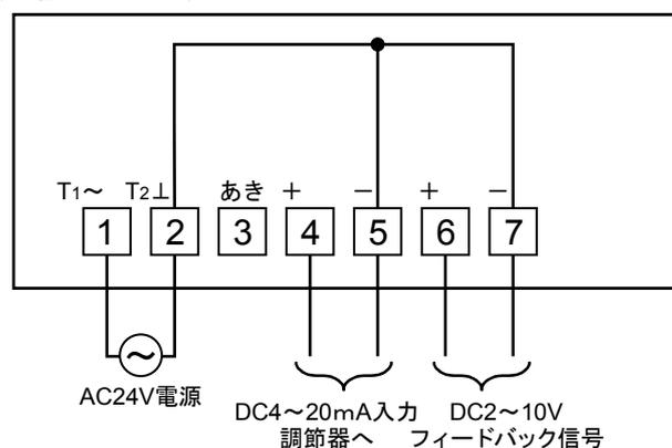
(注記) 端子2 (電源)、端子5 (DC4~20mA入力)、端子7 (DC2~10Vフィードバック信号) は、内部で接続されています。
