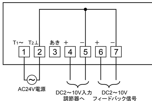
(注記) 端子2 (電源)、端子5 (DC2~10V入力)、端子7 (DC2~10Vフィードバック信号) は、内部で接続されています。
