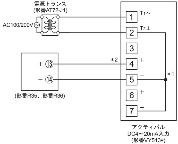
\*1 端子[2] (電源)、端子[5] (DC4~20mA入力)、端子[7] (DC2~10Vフィードバック信号) は、内部で接続されています。
