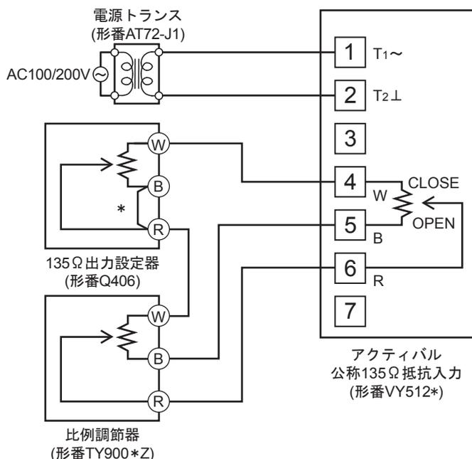
比例調節器とは別に135Ω出力の設定器を追加することで、アクチュエータの最小開度を0～約50%の範囲で設定できます。
