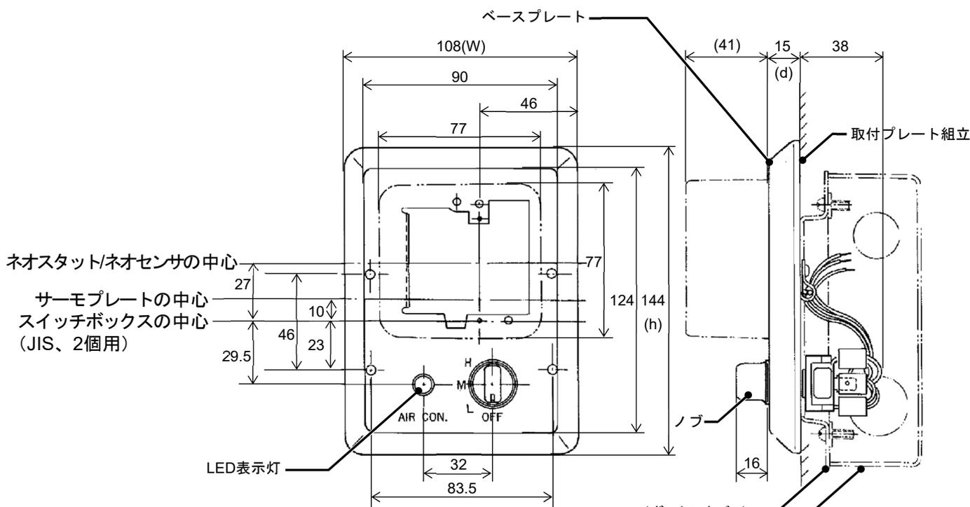
壁表面露出部：縦 (h) × 横 (w) × 厚さ (d) = 144 × 108 × 15 (mm)
