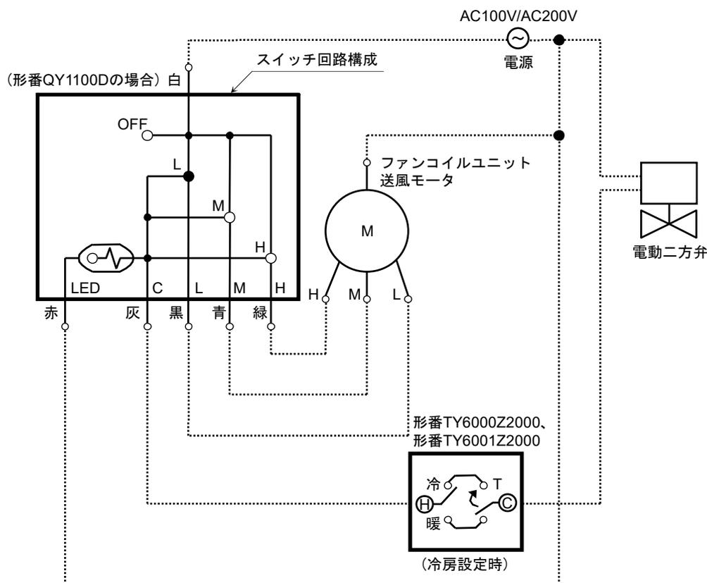
\* 太枠線内の○●は接点を表し、○：オープン ●：クローズとする。図は、スイッチ位置がLのとき。
