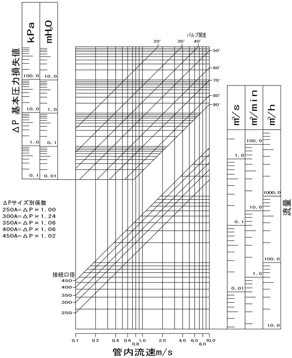
図39 形番VY6962、形番VY9962 パルプ接続口径選定および圧力損失線図 (パルプ接続口径250~450A)
