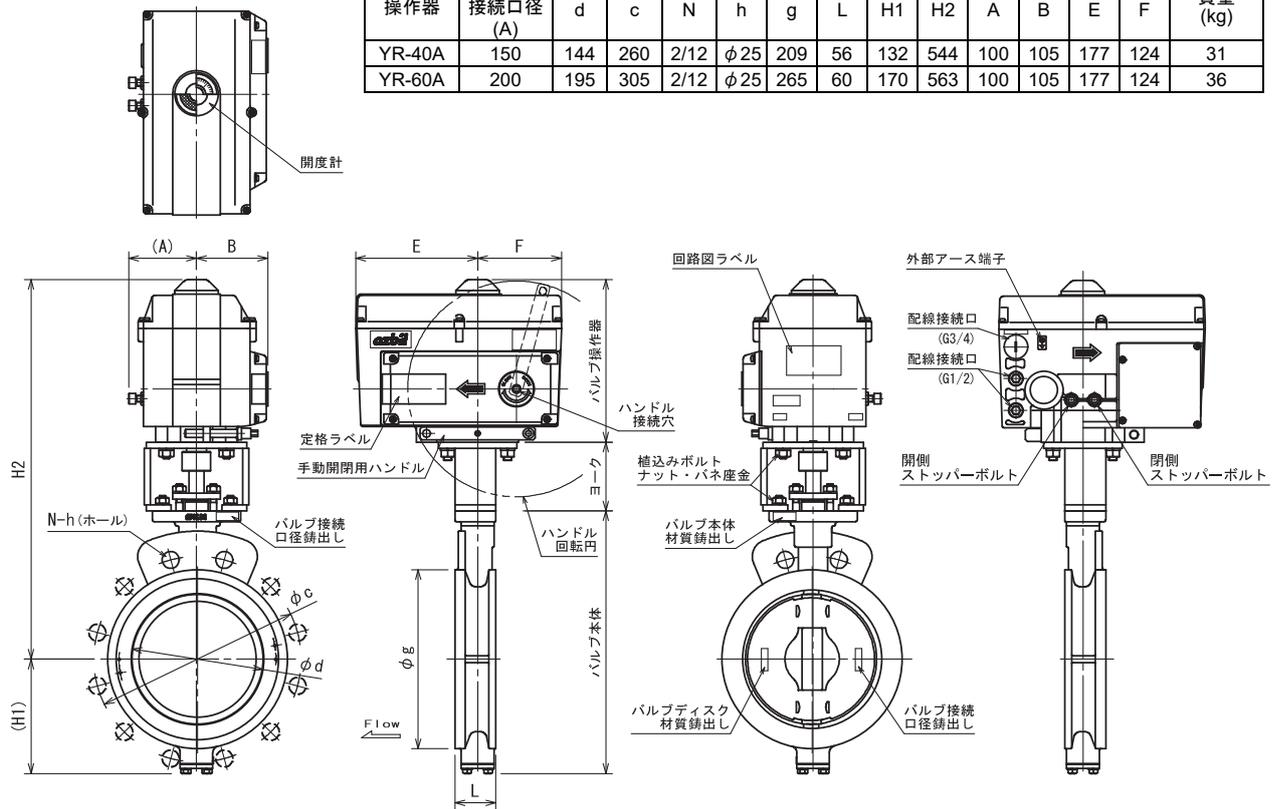
図13 形番VY6964、形番VY9964バルブ接続口径150~200Aの形状・寸法 (mm)
