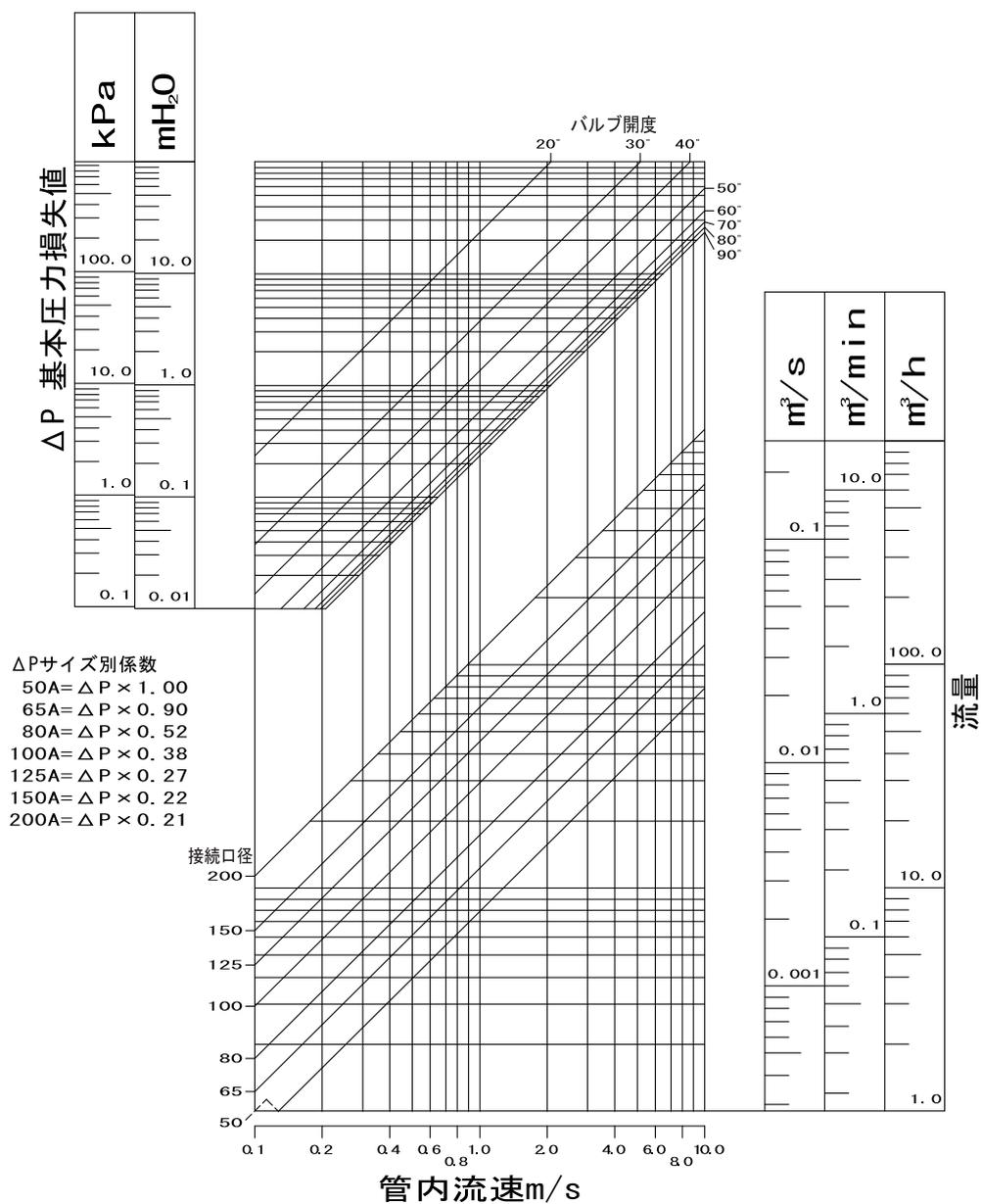
図40 形番VY6963、形番VY6964、形番VY9963、形番VY9964 バルブ接続口径選定および圧力損失線図（バルブ接続口径50～200A）
