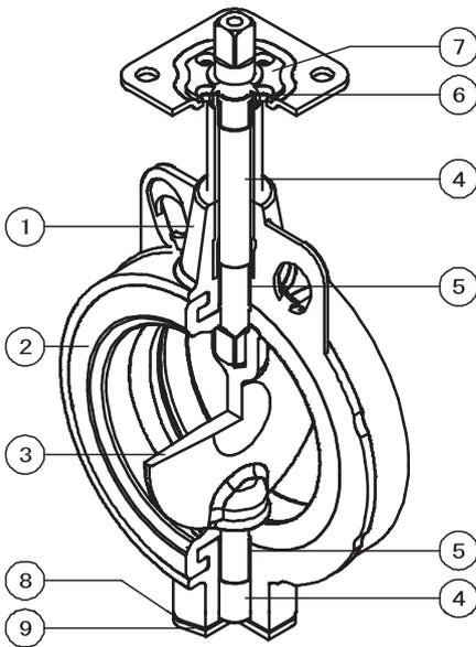
図31 形番VY6967 バルブ接続口径50~300A 構造・材質
