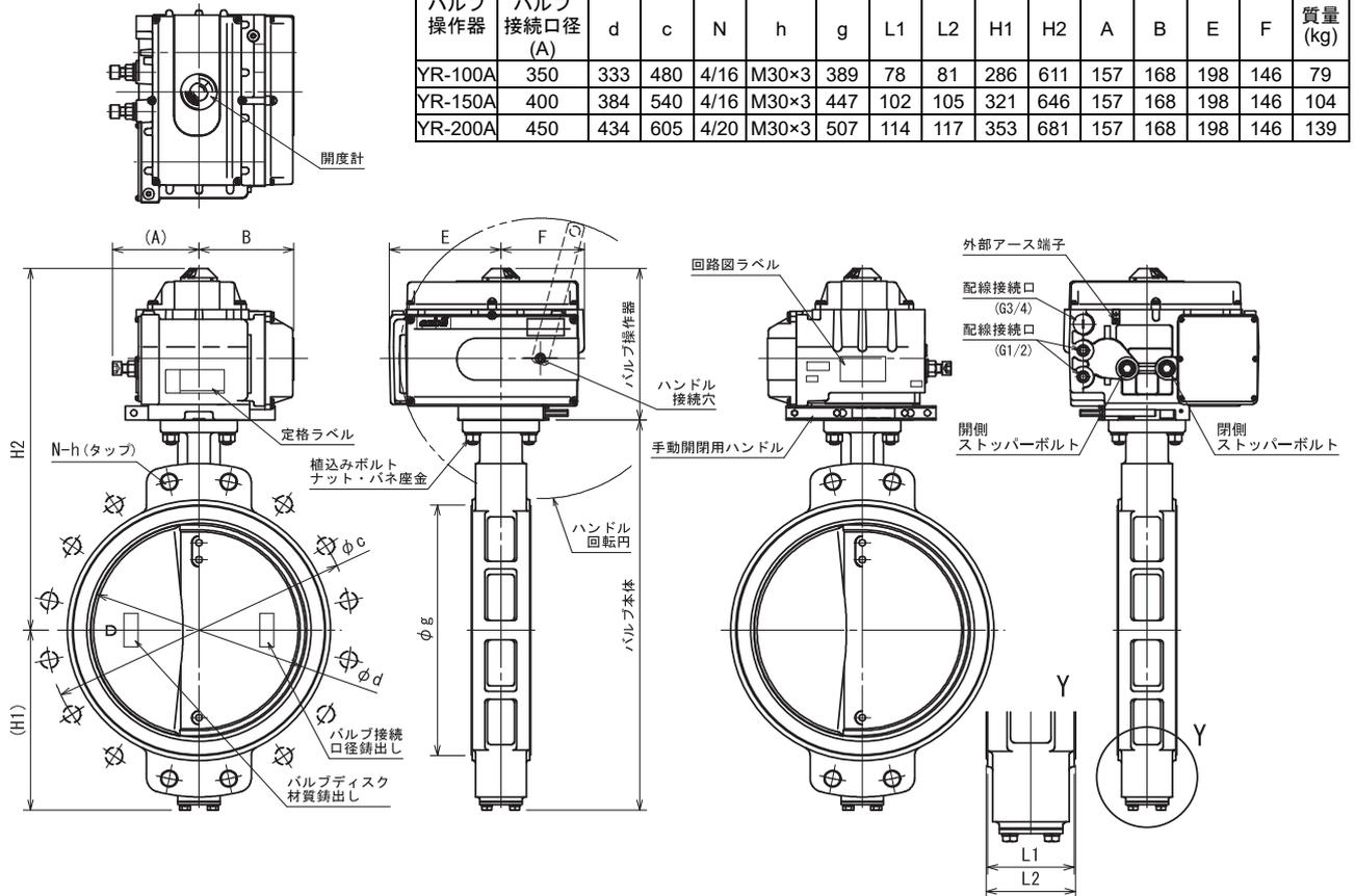
図7 形番VY6962、形番VY9962バルブ接続口径350~450Aの形状・寸法 (mm)
