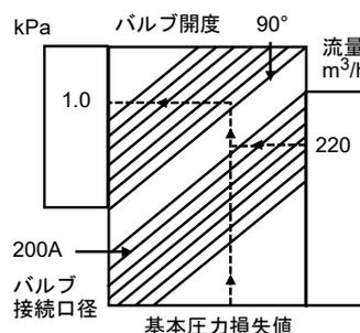
流量220m³/hよりバルブ接続口径へ線を引き、流速を示す縦軸2.0m/sとの交点よりバルブ接続口径を求めます。
