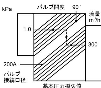
基本圧力損失値1.0kPaよりバルブ開度へ線を引き、バルブ開度90°との交点よりバルブ接続口径へ線を引き、流量300m³/hよりバルブ接続口径へ線を引き、先に引いた線との交点よりバルブ接続口径を求めます。
