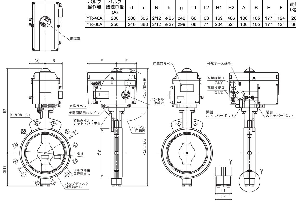
図5 形番VY6962、形番VY9962バルブ接続口径200~250Aの形状・寸法 (mm)
