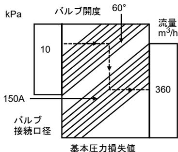
基本圧力損失値10kPaよりバルブ開度へ線を引き、バルブ開度60°との交点よりバルブ接続口径へ線を引く。バルブ接続口径150との交点より流量へ線を引き、そのときの流量を読みます。
