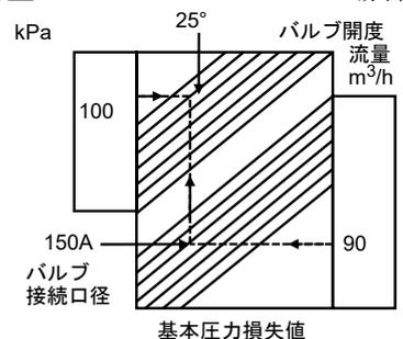
基本圧力損失値100kPaよりバルブ開度へ線を引き、流量90m³/hよりバルブ接続口径150へ線を引き、バルブ接続口径150との交点よりバルブ開度へ線を引き、基本圧力損失値100kPaの線との交点よりバルブ開度を求めます。
