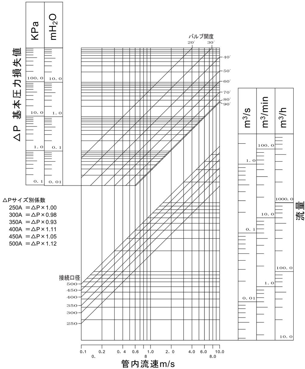
図41 形番VY6963、形番VY6964、形番VY9963、形番VY9964 バルブ接続口径選定および圧力損失線図（バルブ接続口径250～500A）
