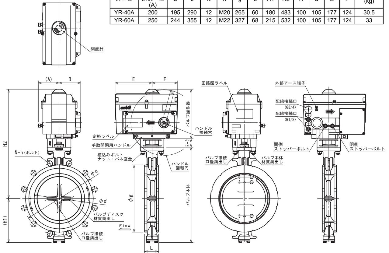
図9 形番VY6963、形番VY9963/バルブ接続口径200~250Aの形状・寸法 (mm)
