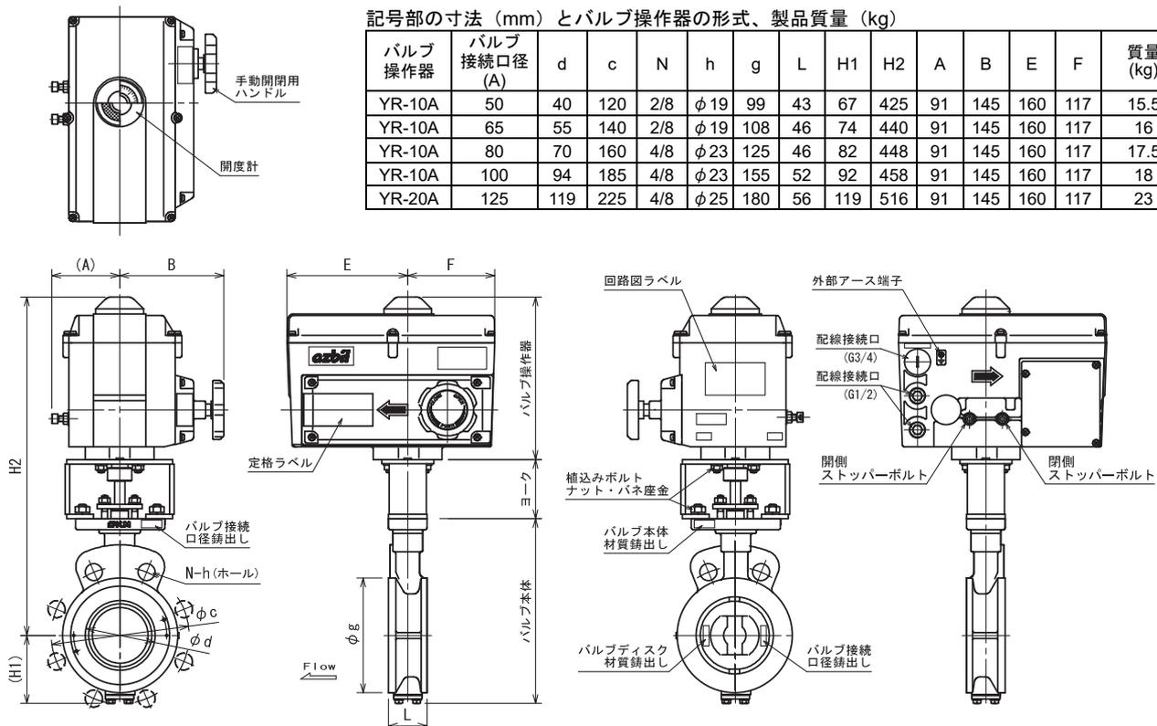
図12 形番VY6964、形番VY9964バルブ接続口径50~125Aの形状・寸法 (mm)
