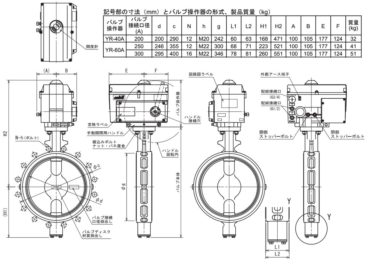
図2 形番VY6961、形番VY9961バルブ接続口径200~300Aの形状・寸法 (mm)
