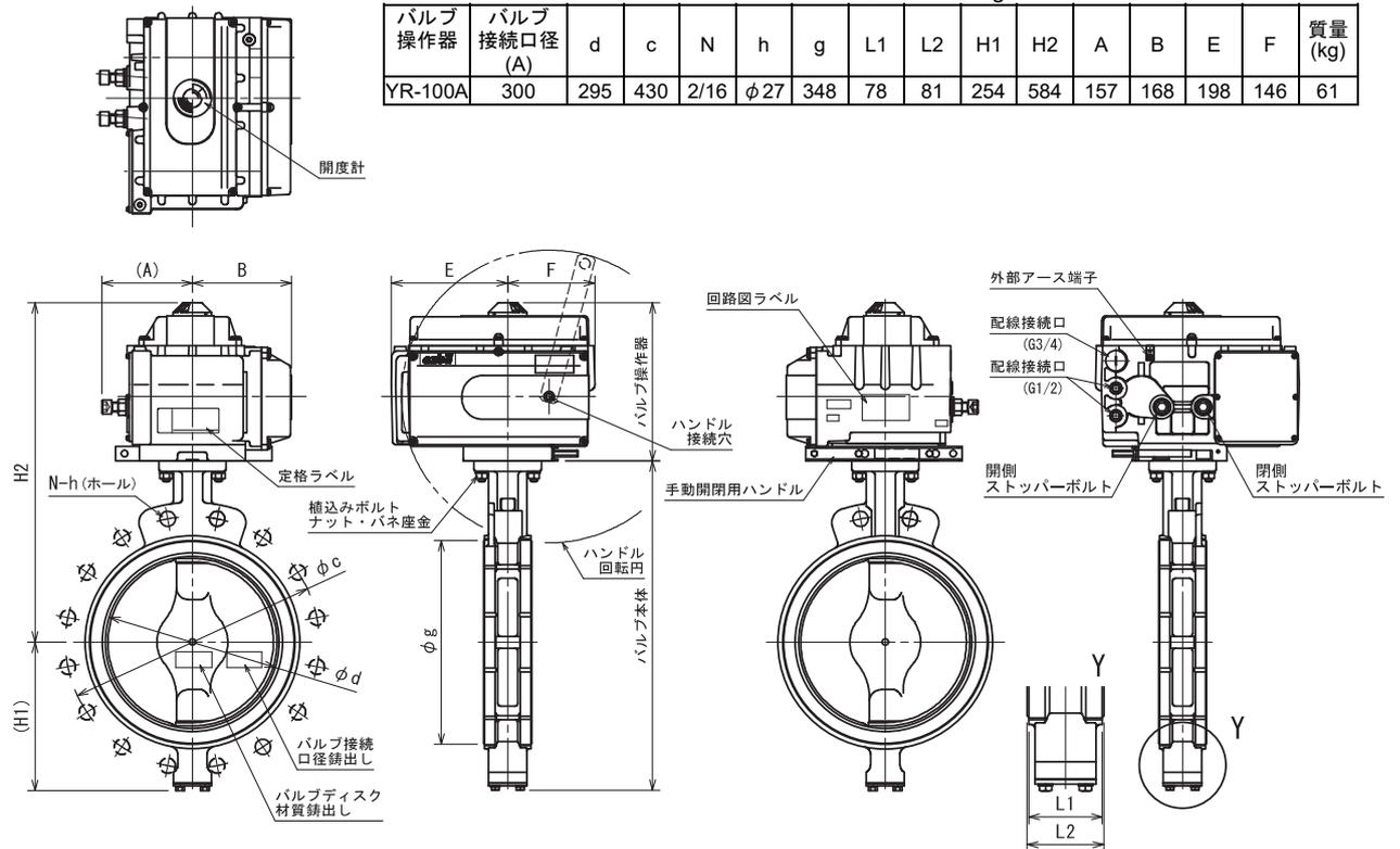
図6 形番VY6962、形番VY9962バルブ接続口径300Aの形状・寸法 (mm)
