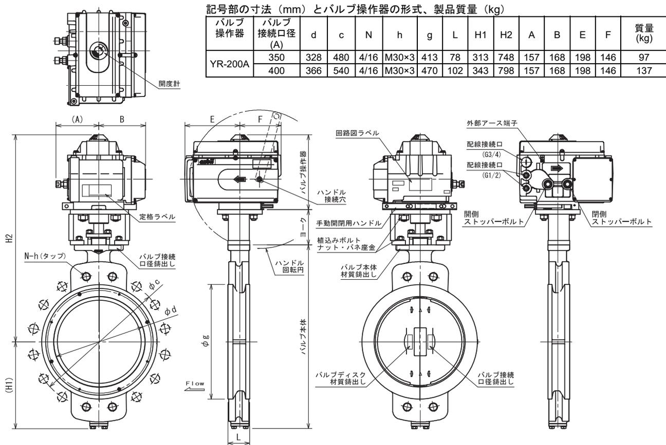
記号部の寸法 (mm) とバルブ操作器の形式、製品質量 (kg)
