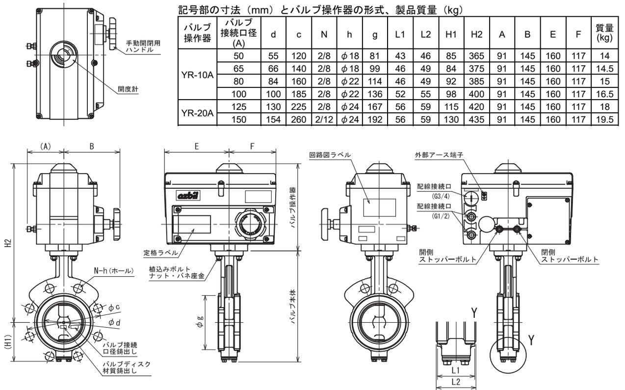
図4 形番VY6962、形番VY9962バルブ接続口径50~150Aの形状・寸法 (mm)
