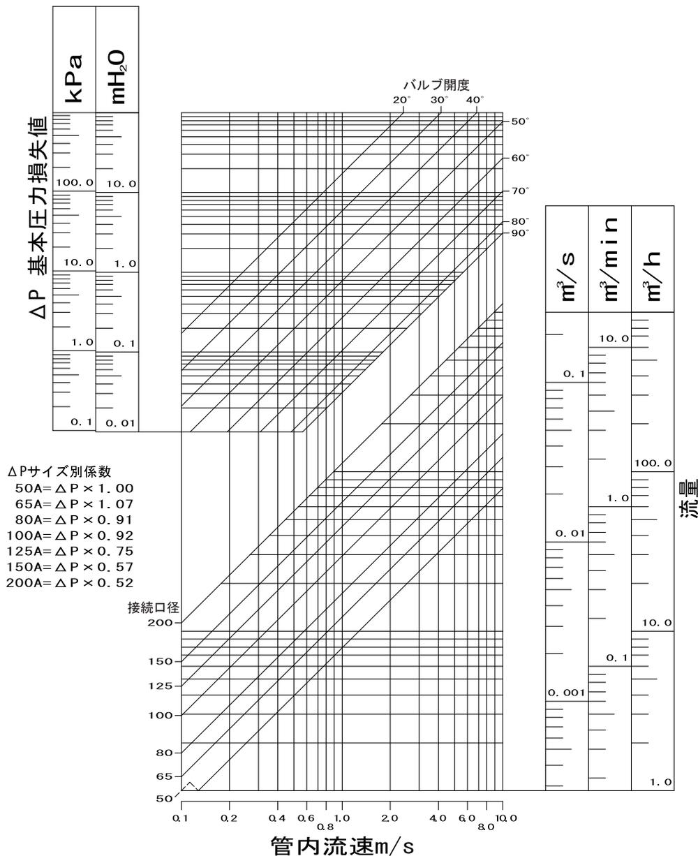
図37 形番VY6961、形番VY6962、形番VY6967、形番VY9961、形番VY9962 バルブ接続口径選定および圧力損失線図 (バルブ接続口径50~200A、流体:水)
