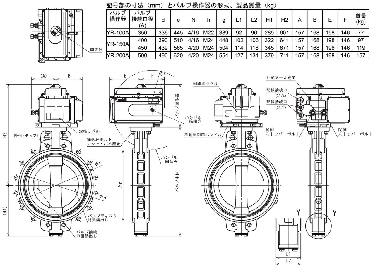
図3 形番VY6961、形番9961バルブ接続口径350~500Aの形状・寸法 (mm)
