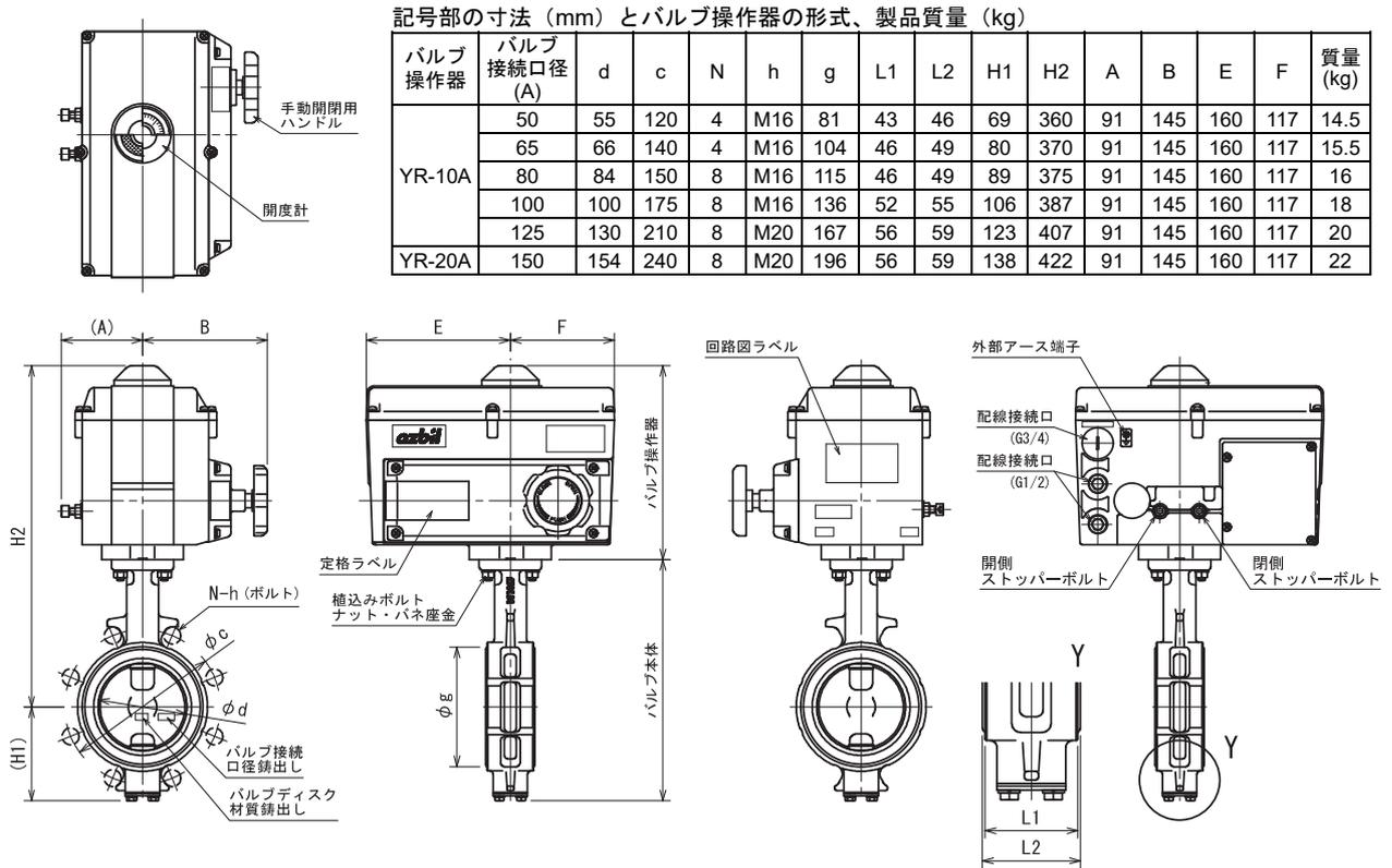
図1 形番VY6961、形番VY9961バルブ接続口径50~150Aの形状・寸法 (mm)
