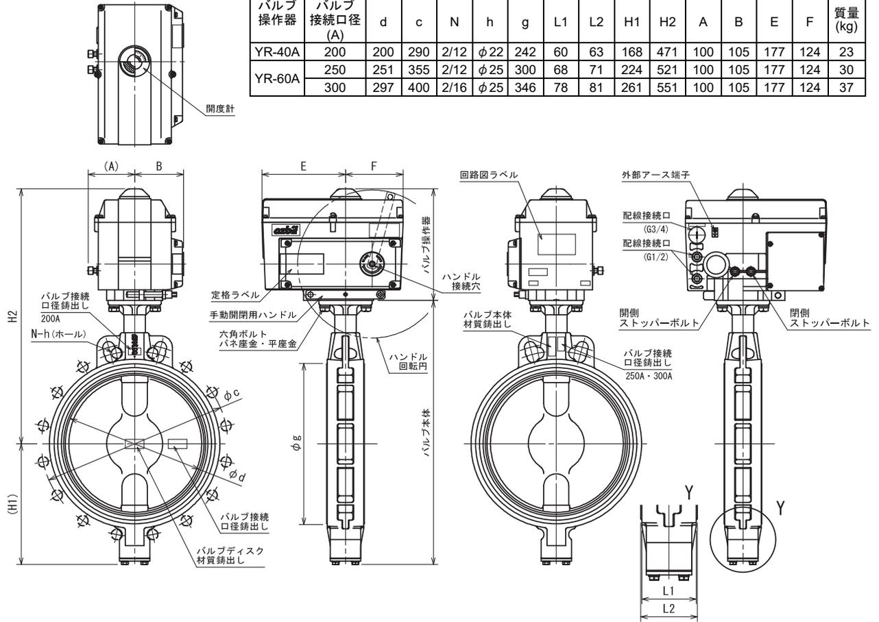
図17 形番VY6967バルブ接続口径200~300Aの形状・寸法 (mm)
