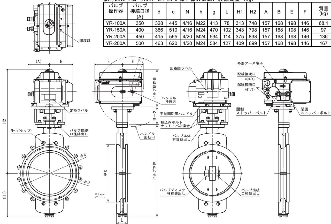
図11 形番VY6963、形番VY9963バルブ接続口径350~500Aの形状・寸法 (mm)
