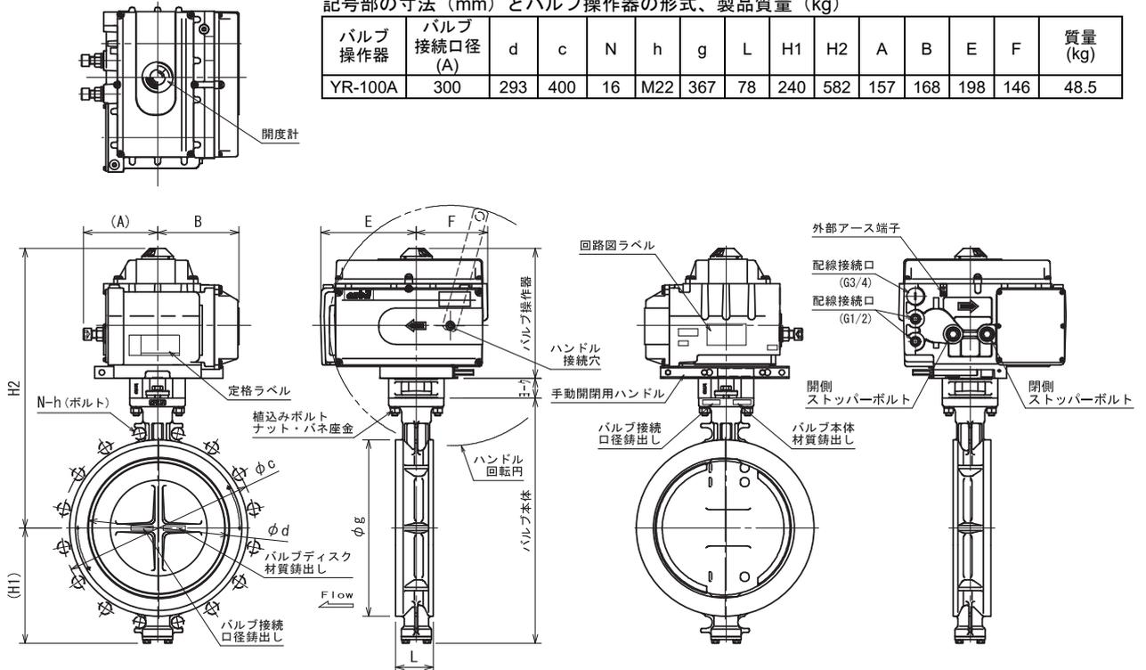
図10 形番VY6963、形番VY9963/バルブ接続口径300Aの形状・寸法 (mm)
