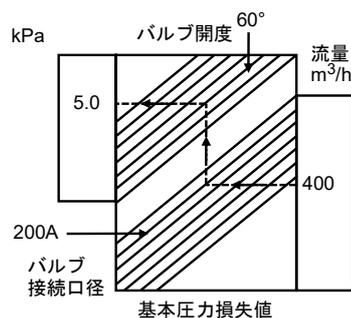
流量400m³/hよりバルブ接続口径へ線を引き、バルブ接続口径200との交点よりバルブ開度60°へ線を引き、その線より基本圧力損失値へ線を引き、そのときの基本圧力損失値を読みます。
