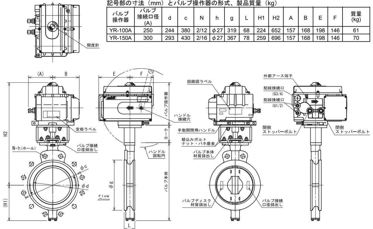
図14 形番VY6964、形番VY9964バルブ接続口径250~300Aの形状・寸法 (mm)
