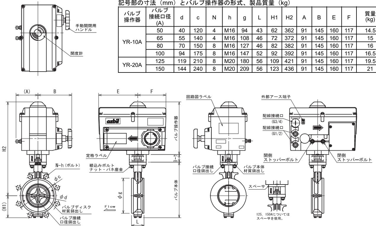
図8 形番VY6963、形番VY9963バルブ接続口径50~150Aの形状・寸法 (mm)
