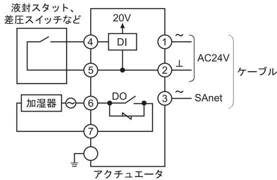
図9 結線例 (基本配線接続例)
